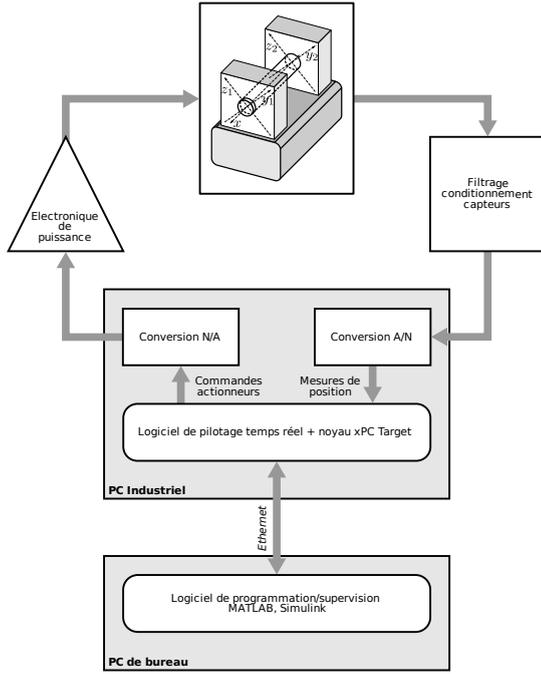
FIGURE 6. Schéma du banc d'essais
