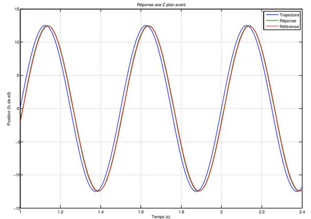
FIGURE 11. Réponse à un sinus sur l'axe  $z_2$
