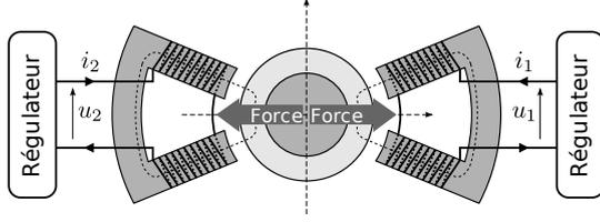
FIGURE 1. Un axe de palier magnétique actif
