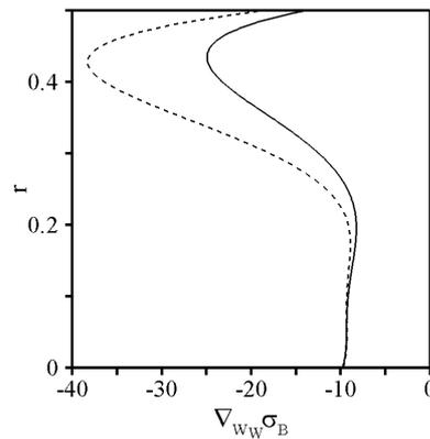
Figure 4: Distribution spatiale de la fonction de sensibilité  $\nabla_{w_W} \sigma_B$  à une vitesse pariétale en fonction de la position radiale sur le culot pour  $Re = 983$  (trait plein) et  $Re = 2000$  (trait pointillé) à  $M = 0.5$ .
